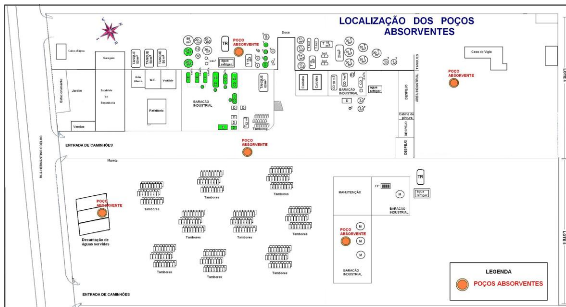
Figura II-3. Localização dos “poços absorventes” utilizados pela Proquima
