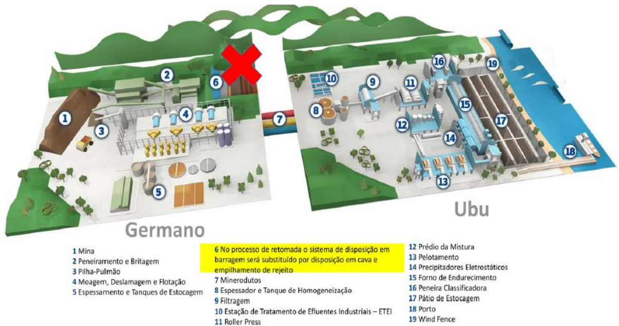
Figura 3: Apresentação esquemática das estruturas e infraestruturas do Complexo do Germano, desde a mina até o porto.
