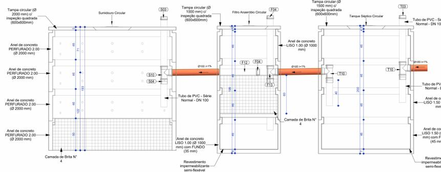
4 Detalhe - Tanque Séptico, Filtro Anaeróbico e Sumidouro
