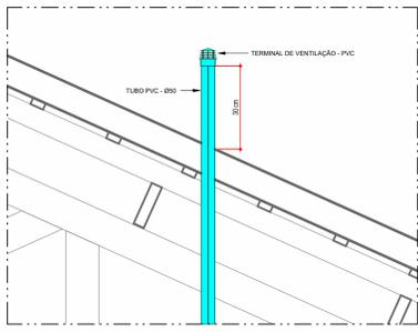
1 (DE-TV) Detalhe - Terminal de ventilação
