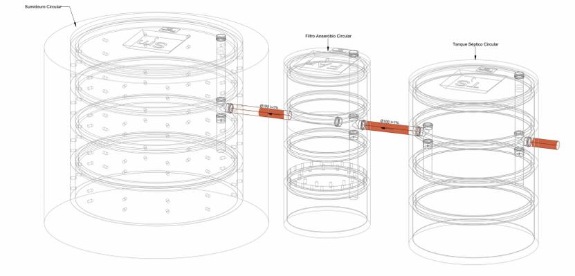
5 Isométrico Tanque séptico, Filtro anaeróbico e Sumidouro
