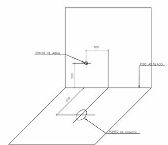
COTAS DOS PONTOS PARA INSTALAÇÃO DE DE BACIA COM CAIXA ACOPLADA SEM ESCALA
