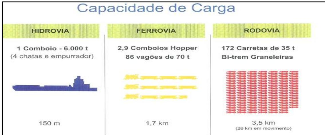
Figura 3 - Comparativo de capacidade de carga e ocupação de espaço físico
