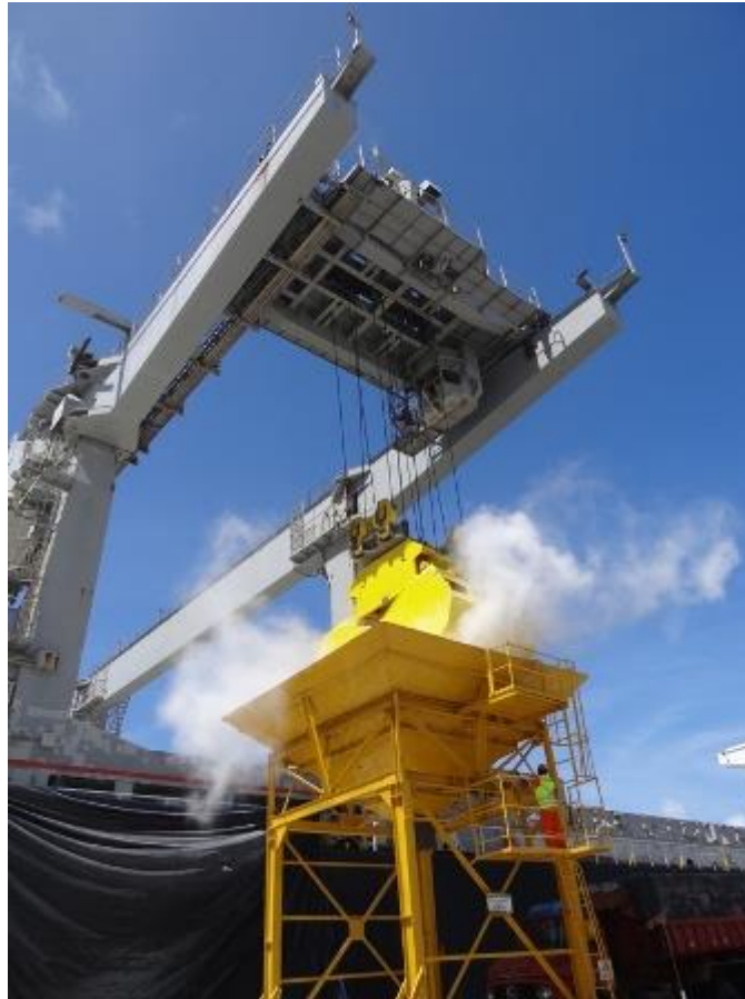
Figura 18. Descarga de Barrilha como Granel Sólido no Recife Fonte: Porto do Recife S.A.
