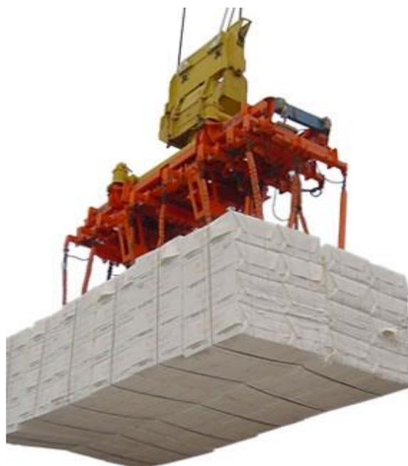
**Figura 16.** Arranjo dos Fardos de Celulose em Lingada para o Embarque
