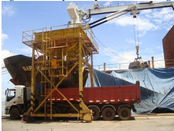
Figura 19 – Caçamba operando com moega
