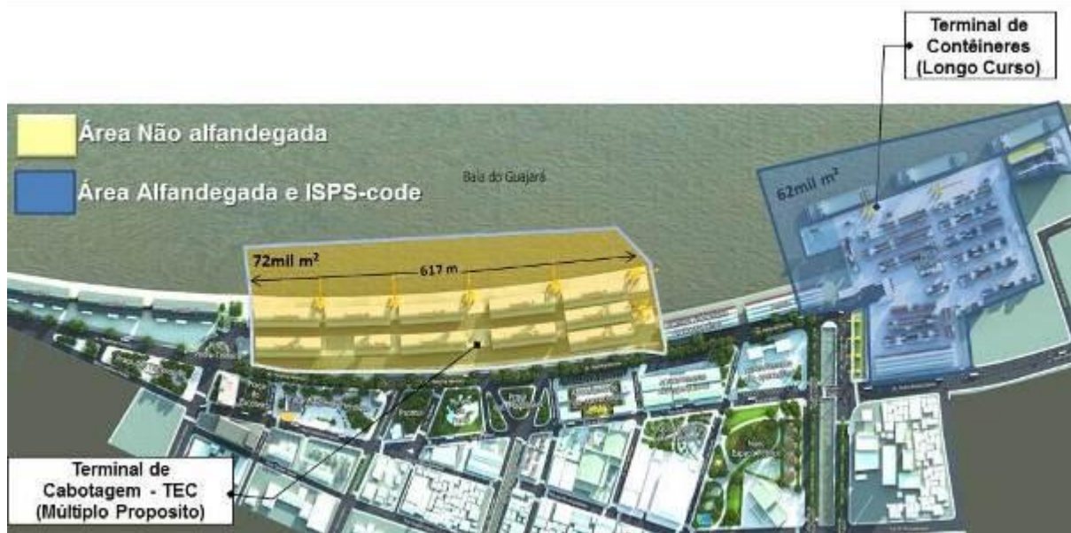
Figura 27 - Proposta de layout, para atendimento a navegação de cabotagem no Porto de Belém Fonte: elaborado pelo autor
