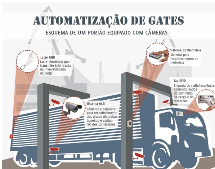
Figura 8 – Esquema de um gate automatizado Fonte: UFSC (2013)
