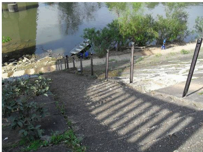
Figura 03. Exemplo de seções de réguas instalada segundo os padrões da ANA (2012).
