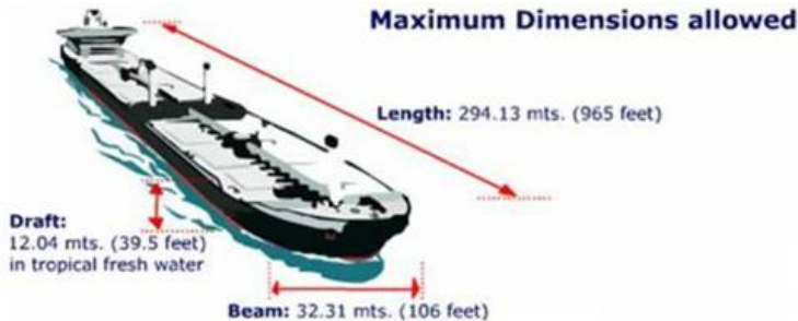
Figura 1 - Canal do Panamá - Dimensões Máximas Permitidas
