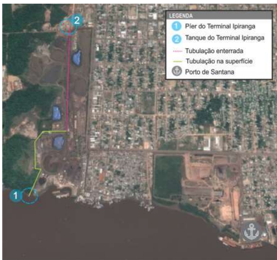
Figura 66 – Duto na área de operação da Ipiranga Fonte: Google Earth (2018). Elaboração: LabTrans/UFSC (2018)
