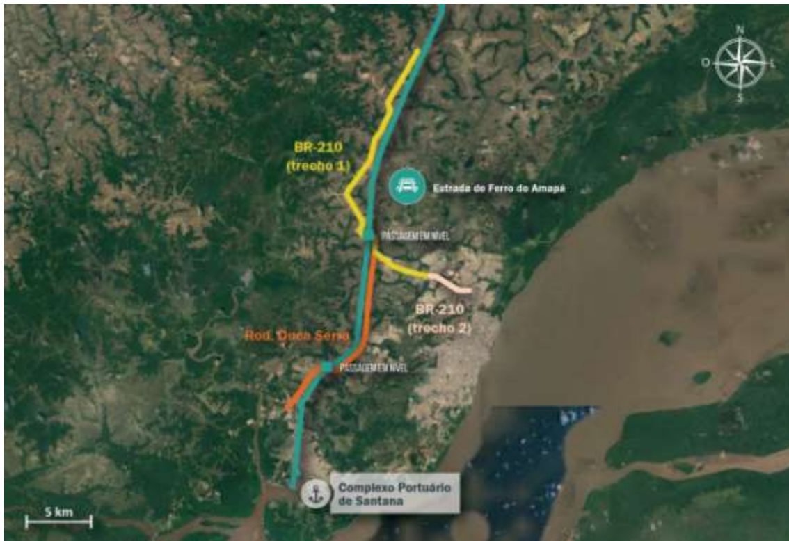
Figura 57 – Cruzamento em nível com a Estrada de Ferro do Amapá Fonte: Brasil (2017). Elaboração: LabTrans/UFSC (2018)
