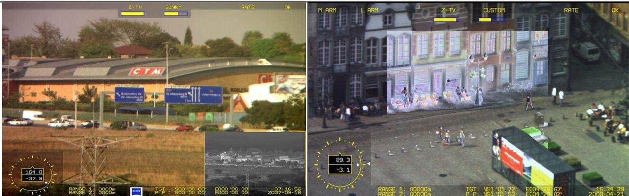
Fusão de imagem de luz e sensores de infravermelhos para fornecer uma imagem com as informações combinadas de ambos os sensores ao mesmo tempo para uso operacional reforçado, recebendo as informações como com dados de IR aumentando as operações durante o dia olhando para objetos de interesse nas sombras ou obtenção de informações de assinatura de calor e para orientação à noite usando informações visíveis tais como cores de luz e consciência situacional.
