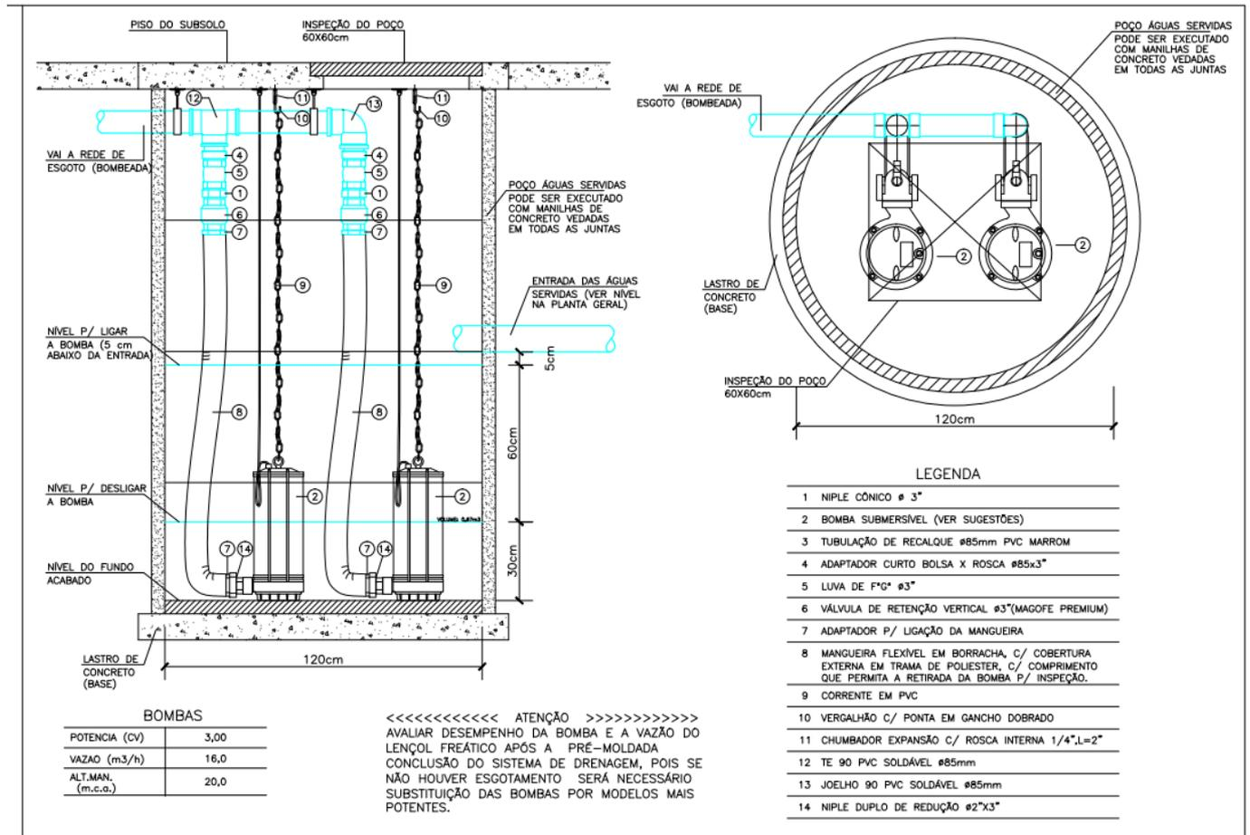
**DETALHE - BOMBEAMENTO DRENAGEM**
