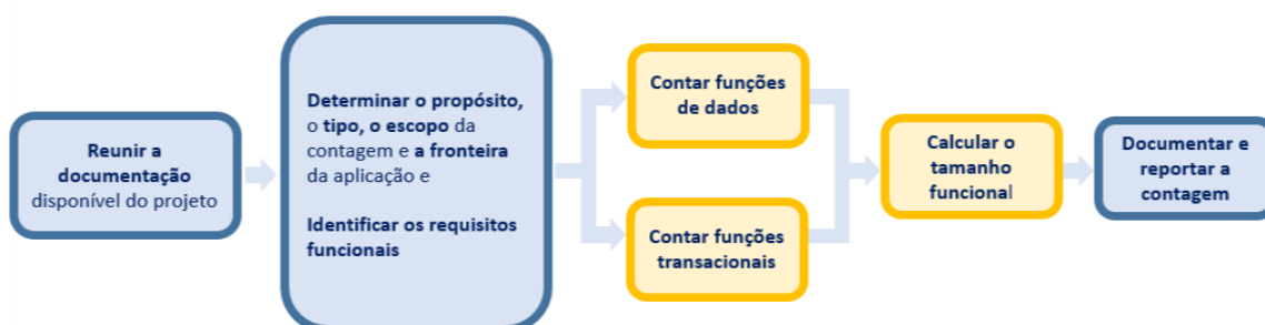
Figura 1: Processo de contagem de Pontos de Função com atividades em destaque
