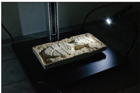
Uma prova maior, como a moldagem de sapatos pode ser fotografada levantando a câmera montada e usando o ajuste da coluna. A foto resultante é viabilizada pelo uso de luz branca de um ângulo oblíquo. (Câmera não inclusa)
