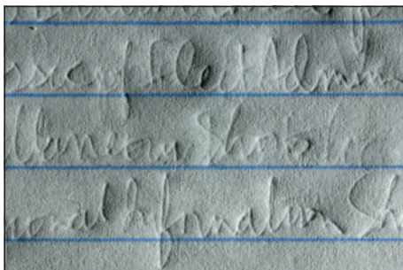
Luz branca oblíqua usada com uma câmera digital SLR com macrolentes para fotos tiradas em close das marcas de escrita. (Câmera não inclusa)
