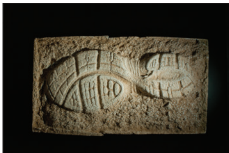
Uma prova maior, como a moldagem de sapatos pode ser fotografada levantando a câmera montada e usando o ajuste da coluna. A foto resultante é viabilizada pelo uso de luz branca de um ângulo oblíquo. (Câmera não inclusa)
