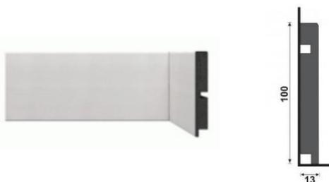
**REF.:** RODAPÉ DE ALTURA 100MM X LARGURA 13MM X COMPRIMENTO 2400MM, PRODUZIDO COM POLIESTIRENO RECICLADO.
