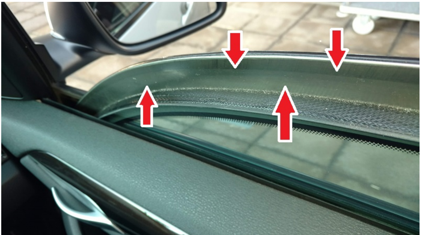
Figura 6 - Detalhe do reforço em aço na região do offset do vidro da porta dianteira.
