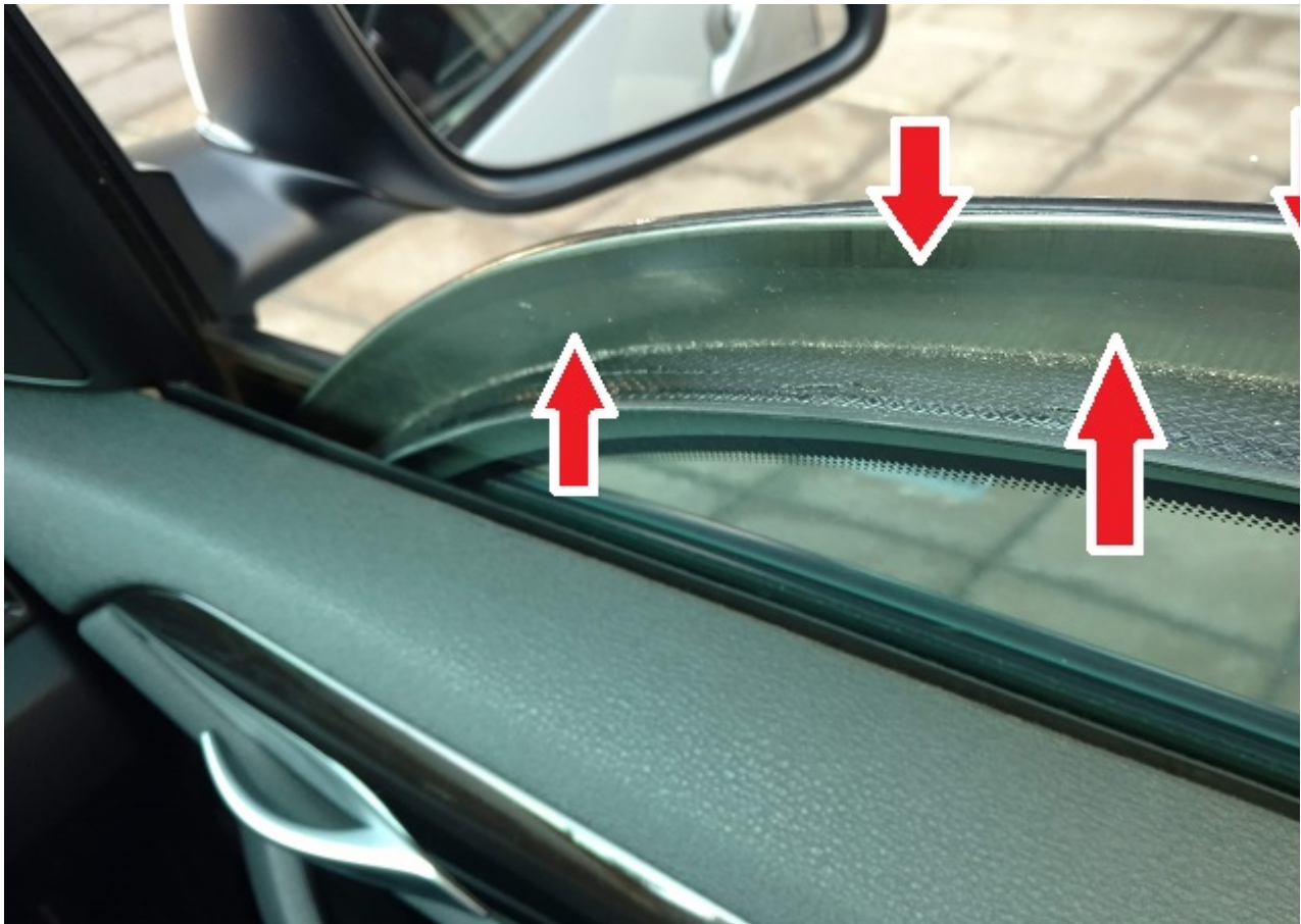
Figura 9- Detalhe do reforço em aço na região do offset do vidro da porta dianteira.
