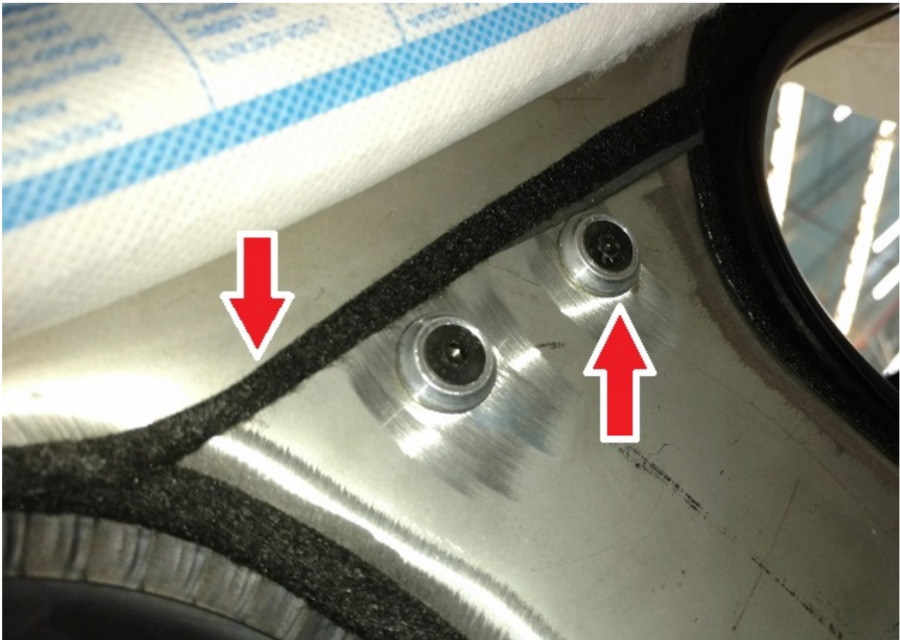
Figura 4 - Detalhe da fixação das chapas de aço inox no interior do veículo com rebites de rosca e da fita de feltro.
