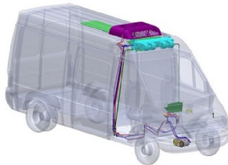
Figura 19 - Esquema ilustrativo do ar condicionado
