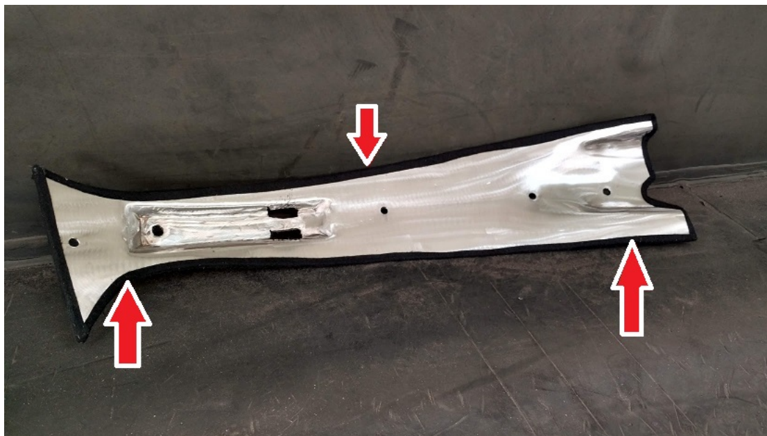
Figura 6 - Detalhe da aplicação da fita feltro nas bordas das chapas de aço.
