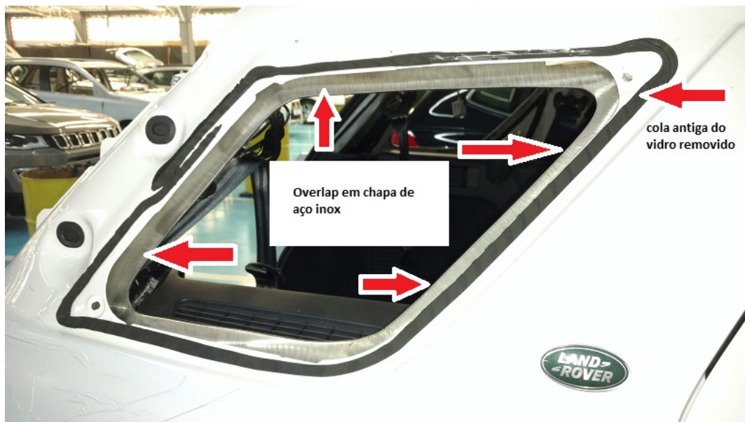
Figura 5 - Exemplo de overlap nos quadros dos vidros fixos
