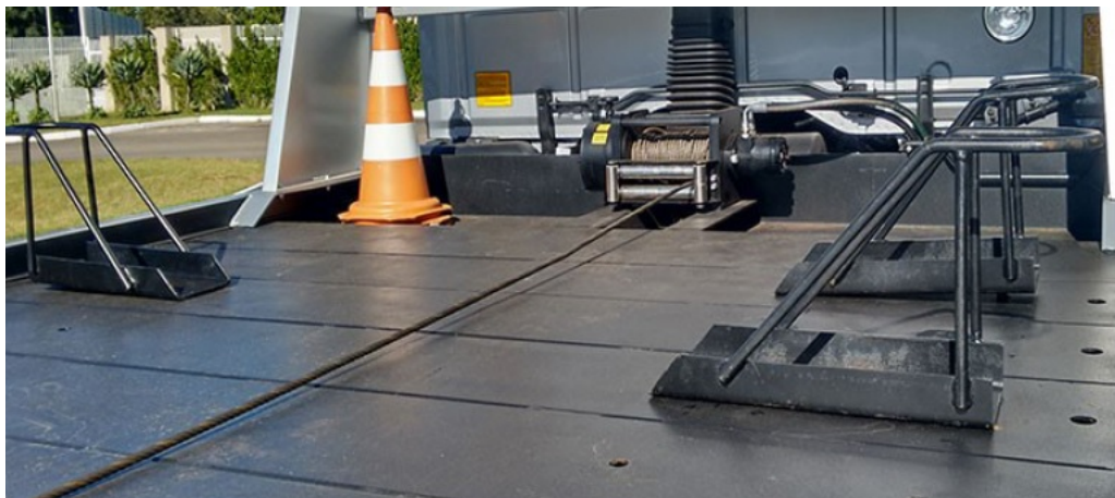
figura 3 - Suporte para transporte de motocicletas
