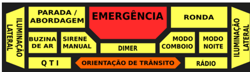
figura 1 - Painel de controle da sinalização visual e sonora das viaturas ostensivas
