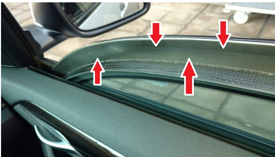
Figura 9- Detalhe do reforço em aço na região do offset do vidro da porta dianteira.
