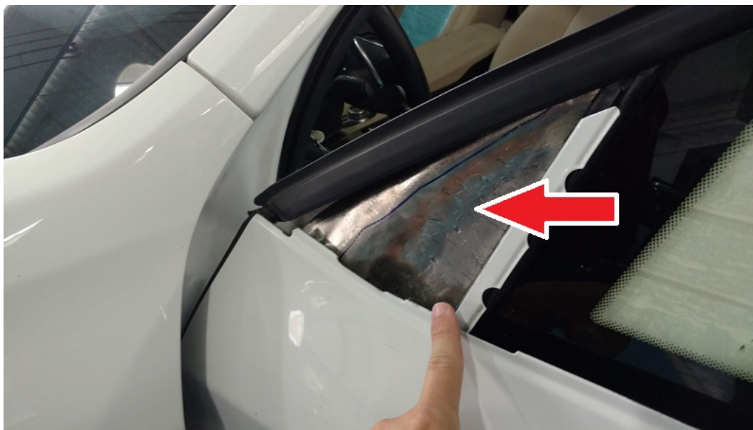
Figura 14 - Chapa de aço inox aplicada na região do retrovisor externo.
