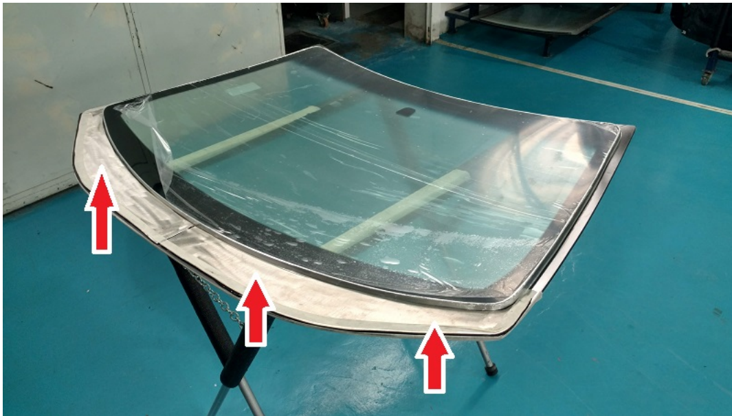
Figura 8 - Reforço em aço inox na região do offset (sorriso) do para-brisa.
