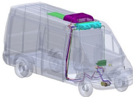
Figura 19 - Esquema ilustrativo do ar condicionado
