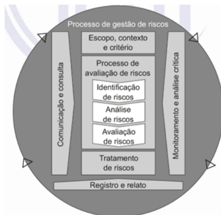
Figura 7 - Diagrama do processo de gestão de riscos da norma ABNT NBR ISO 31000:2018 - Diretrizes
