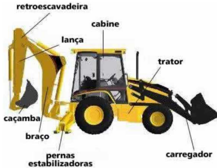
Imagem1: Partes que compõem a retroescavadeira
