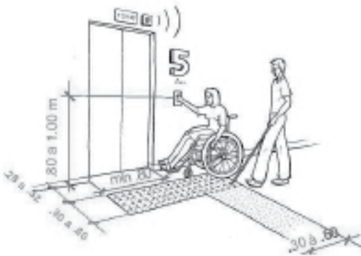
Elevador com piso guia, piso de alerta, alarme sonoro e sinalização visual
