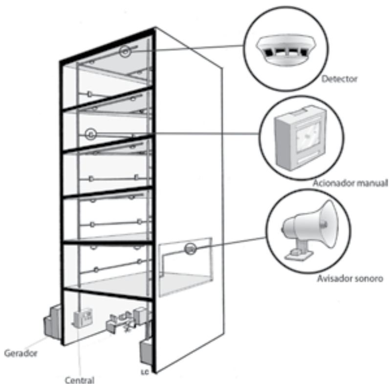
Figura 3.8 – Sistema de detecção e alarme de incêndio e seus componentes
