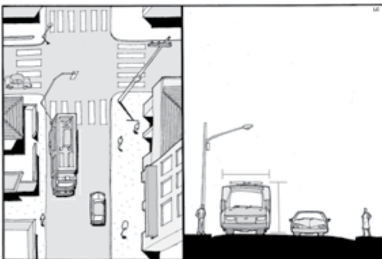
Figura 3.3 – Vias públicas adequadas ao trânsito de veículos de bombeiros
