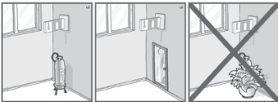
Figura 3.11 – Condições de instalação e sinalização de extintores de incêndio
