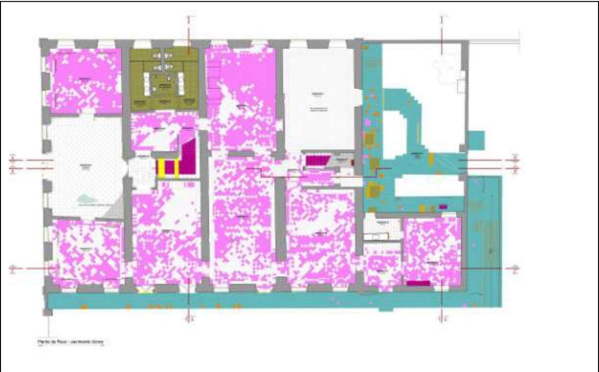
Figura – Padrão de representação para o mapeamento de danos na planta de pisos.
