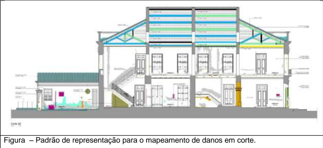
Figura – Padrão de representação para o mapeamento de danos em corte.
