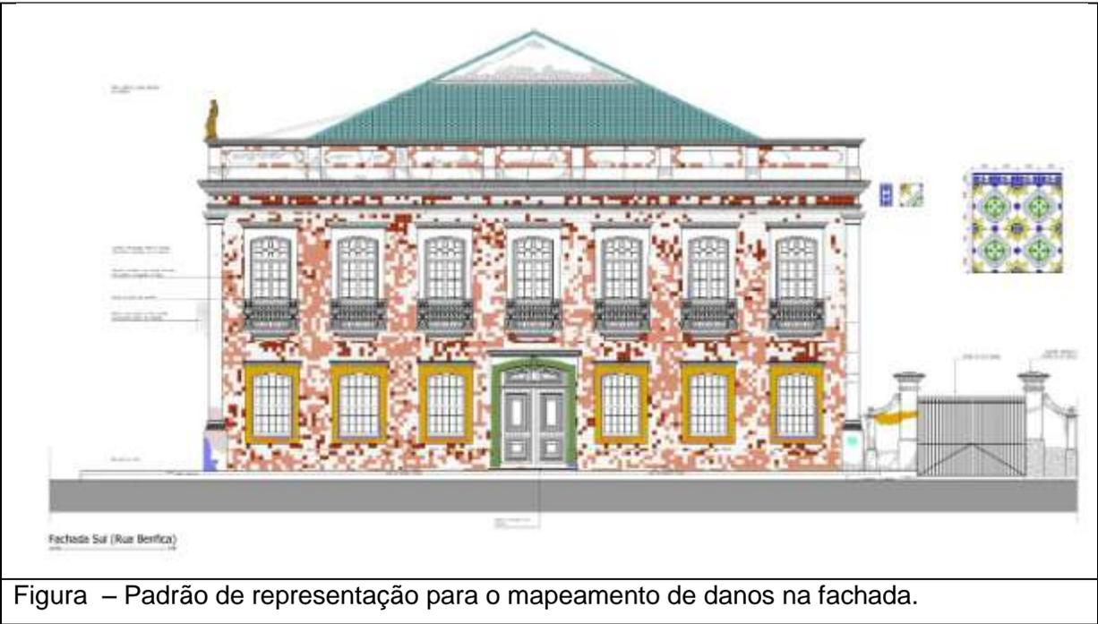
Figura – Padrão de representação para o mapeamento de danos na fachada.
