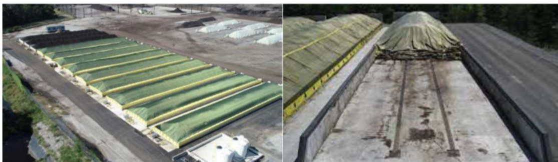
Figura 35 – Sistemas de compostagem e biossecagem com mantas de cobertura semipermeável Gore® HeapCover
