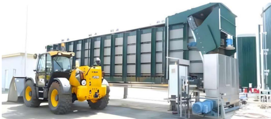
Figura 21 – Detalhe do sistema de alimentação e operação com trator pá carregadeira
