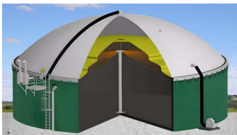
Figura 23 – Detalhe do biodigestor CSTR estrutura interna e externa
