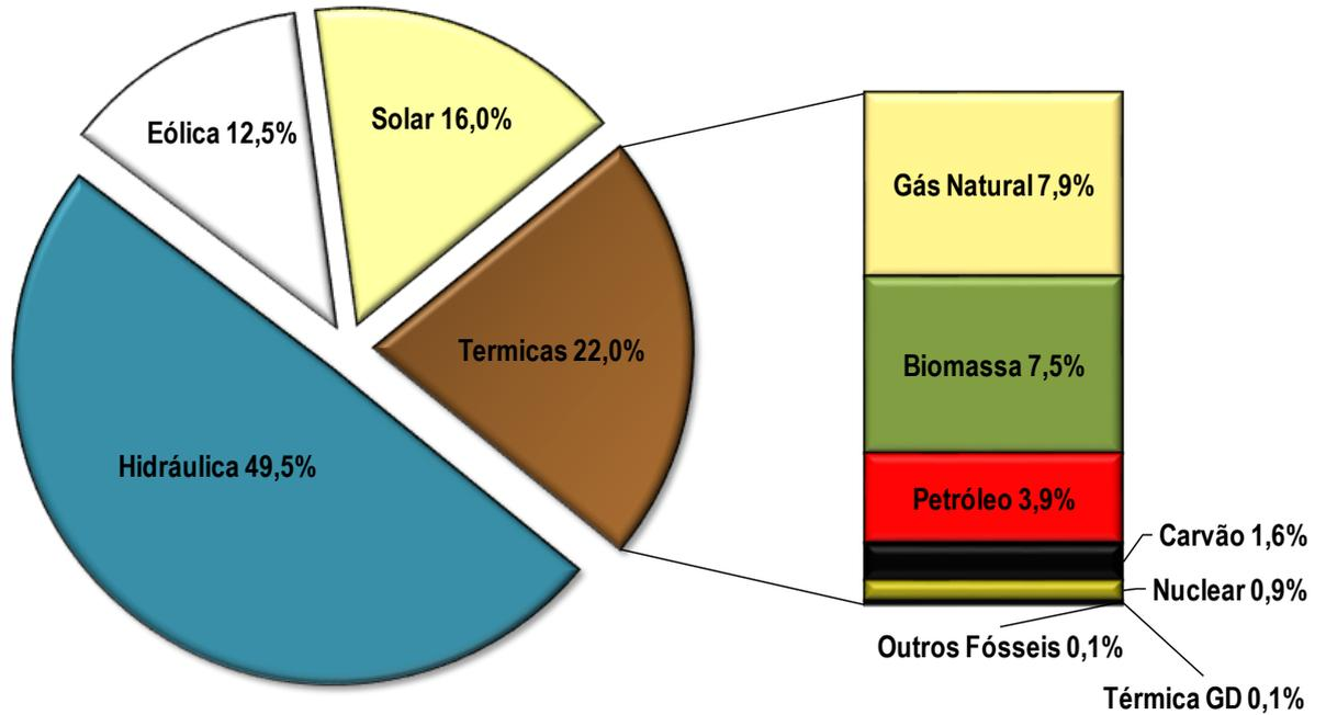
Figura 18. Matriz de capacidade instalada de geração de energia elétrica do Brasil, sem importação contratada.
