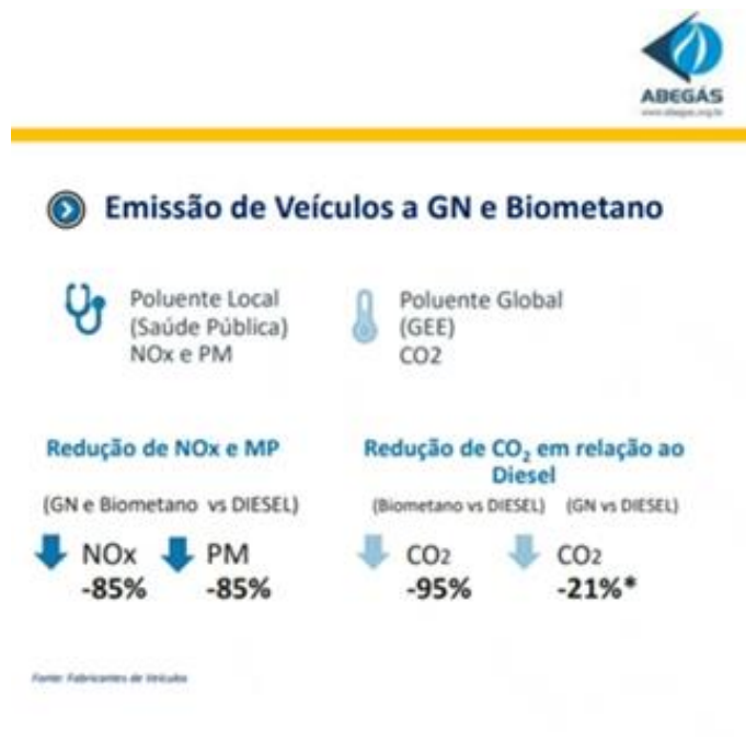
Figura 3.1: Comparação da redução de emissões de GN e biometano em relação ao diesel.
