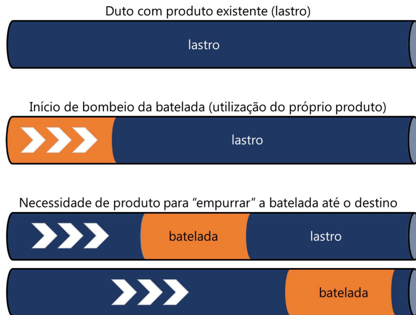
Figura 2 – Ilustração da movimentação de produtos em um poliduto
