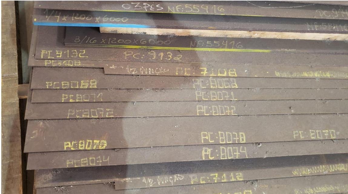
Figura 3 – Detalhes das identificações de chapas (Planos de Corte – PC)
