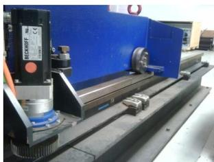
Combinado ao uso de acionamentos e motores CA Beckhoff de 2,45 Nm, com um redutor planetário de duplo estágio, o sistema proporciona alto torque e resolução, que se traduz em uma perfeita sincronia nos movimentos.
