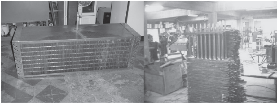
Figura 5.19 - Montagem dos trocadores de calor
