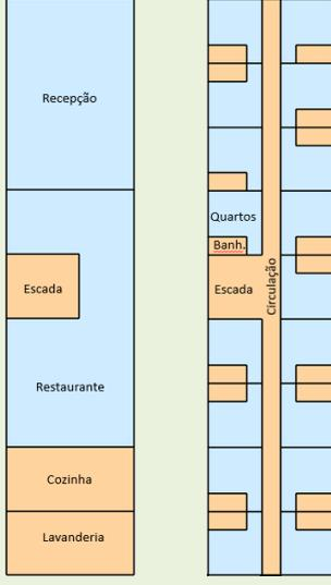
Figura 1. Planta dos pavimentos – 34 quartos e área total de 929,88 m<sup>2</sup>
