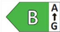
Figura 2: Seta colorida esquerda, com indicação da gama de classes de eficiência energética
