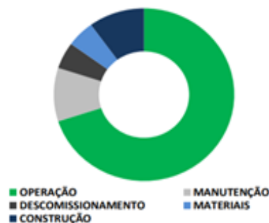
Figura 6 - Representação Esquemática de Consumo de Energia em Edificações em seu Ciclo de Vida (EPE, 2020)
