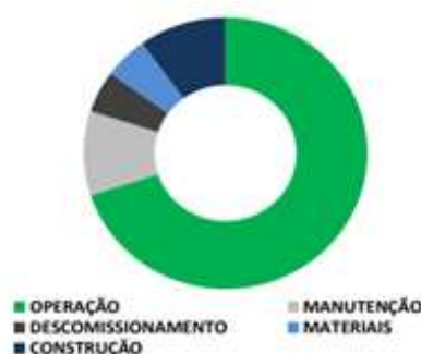
Figura 7 - Representação Esquemática de Consumo de Energia em Edificações em seu Ciclo de Vida (EPE, 2020)
