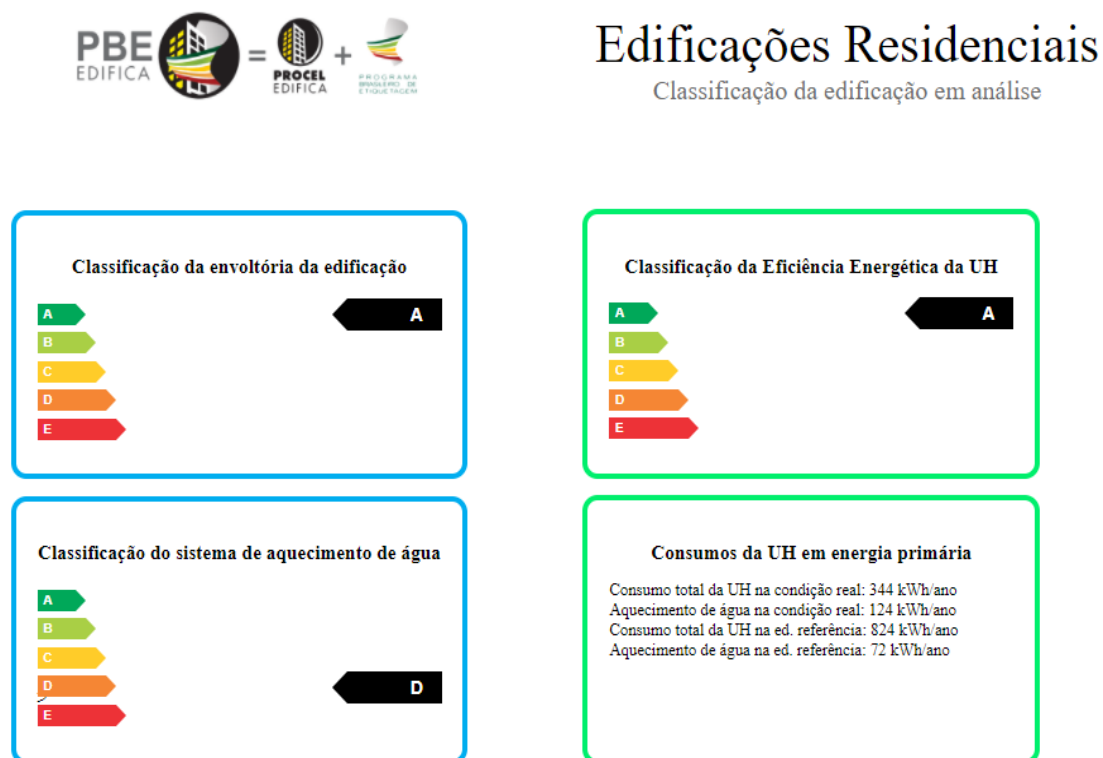
Figura 64 - Interface da apresentação dos resultados de classificação da edificação em análise da ferramenta online para INI-R. Fonte: PBE Edifica, 2022.
