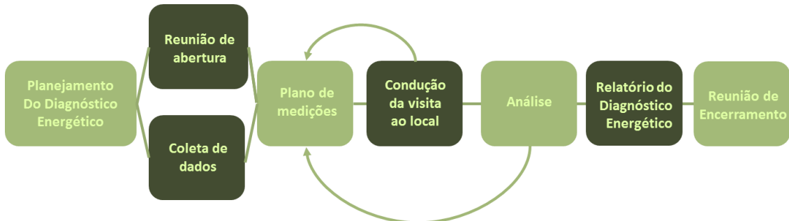
Figura 3. Fluxograma do processo de diagnóstico energético. Fonte das informações: ISO 50.002. Fonte da imagem: Mitsidi Projetos.
