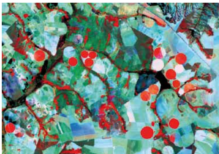
Figura 7. Exemplo de composição colorida de imagem do satélite Landsat ETM+ da região de Cristalina/MG, mostrando áreas circulares no recorte de imagem, associadas a sistema de irrigação por pivô-central.
