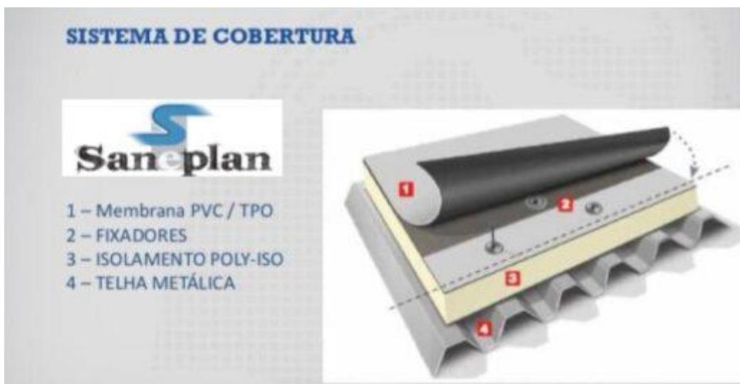
Figura 1 - Esquemas de fixação da manta de TPO/PVC fornecidos pela SANEPLAN
