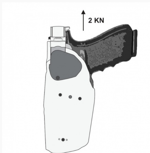
Resistência mínima do Sistema de Retenção do Armamento.
