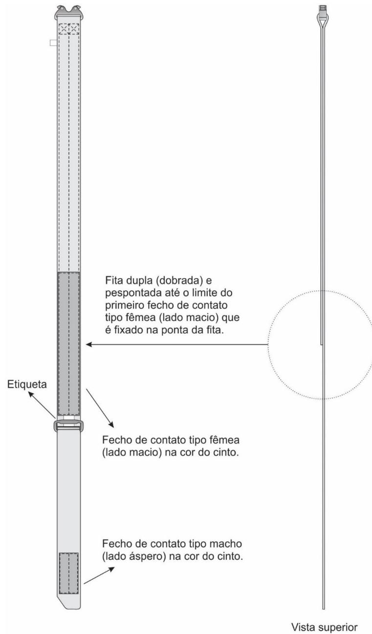
**Figura 6 – Detalhes da faixa e fechos de contato do cinto**
