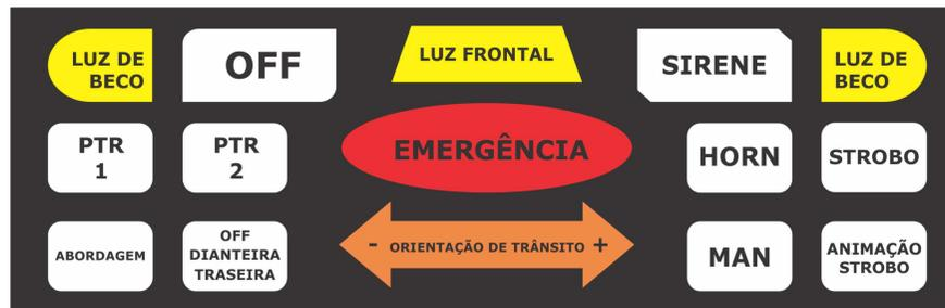
O painel de controle deverá ter o tamanho de 190 x 60 mm (comprimento e altura respectivamente) e seu desenho e as funções das teclas deve seguir fielmente o exposto acima;
