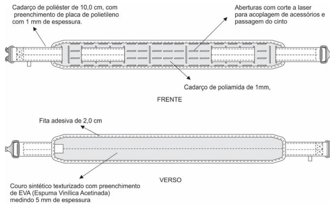
Figura 3 – Detalhes do cinturão montado com o cinto de guarnição
