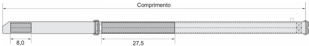
Figura 5 – Detalhes da face externa do cinto
