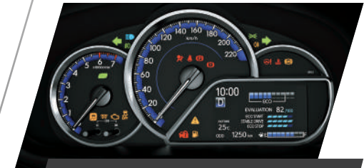
Painel digital de alta resolução Computador de bordo com até 16 funções 1
