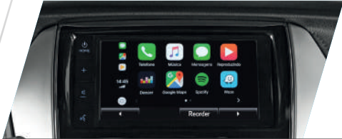
Sistema de áudio Central Multimídia Toyota Play+ com Tecnologia Harman ® , tela sensível ao toque de 7" e conexão para smartphone e tablets por meio do espelhamento SDL1, Android Auto ® e Apple Car Play ®
