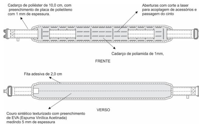
Figura 3 – Detalhes do cinturão montado com o cinto de guarnição
