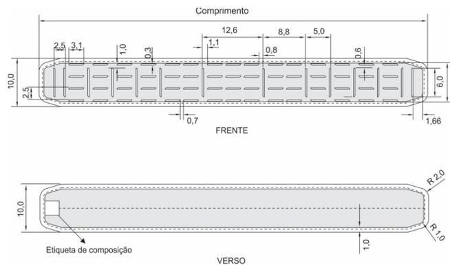
Figura 2 – Detalhes da frente e verso do cinturão
