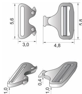
Figura 4 – Dimensões em cm das fivelas macho e fêmea
