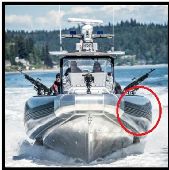
Foto ilustrativa do Sistema de Proteção dos Flutuadores "rubstrike"
