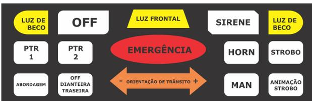
O painel de controle deverá ter o tamanho de 190 x 60 mm (comprimento e altura respectivamente) e seu desenho e as funções das teclas deve seguir fielmente o exposto acima;
