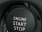
Smart Entry + Start Button/Push Start Entrada e partida ao simples toque, sem a necessidade de uso da chave (acionamento por proximidade) 1
